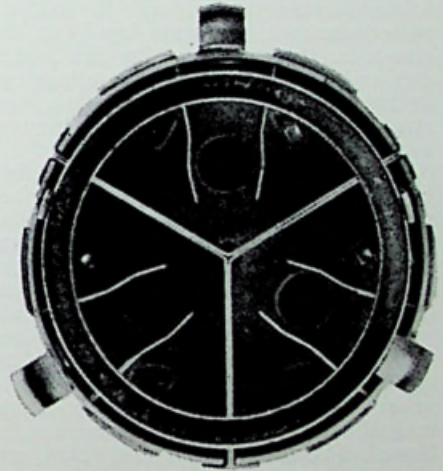
Fig. 24 - Het elektronenstraalsysteem van een kleurbeeldbuis met de drie guns, die we hier als zwarte gaten zien. De metalen strippen ter weerszijden van elke gun zijn poolschoenen voor de (magnetische) correctiesystemen, die zich buiten de hals bevinden; wij komen hier op terug.
